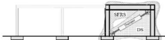
تمامی اعضای سامانه میراگر با سیستم باربر لرزه ای سازه مشترک میباشند
