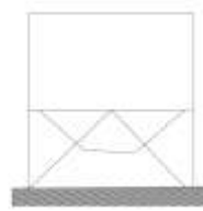
بونکر یا کندو روی پایه ها با یا بدون مهاربندی R_{ii} = 3 یا 2
