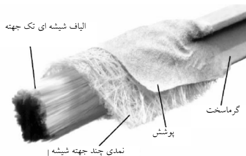
شکل (۱): نمایی از مقطع میله I پالتروود شده [۱۶]
